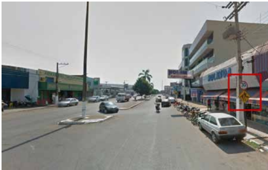
Figura 10: Largura da via incompatível com a velocidade estipulada
